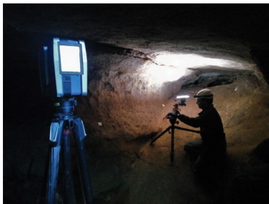
Figura 2 – Escaneo 3D de cavidades y fotogrametría de paneles decorados.
